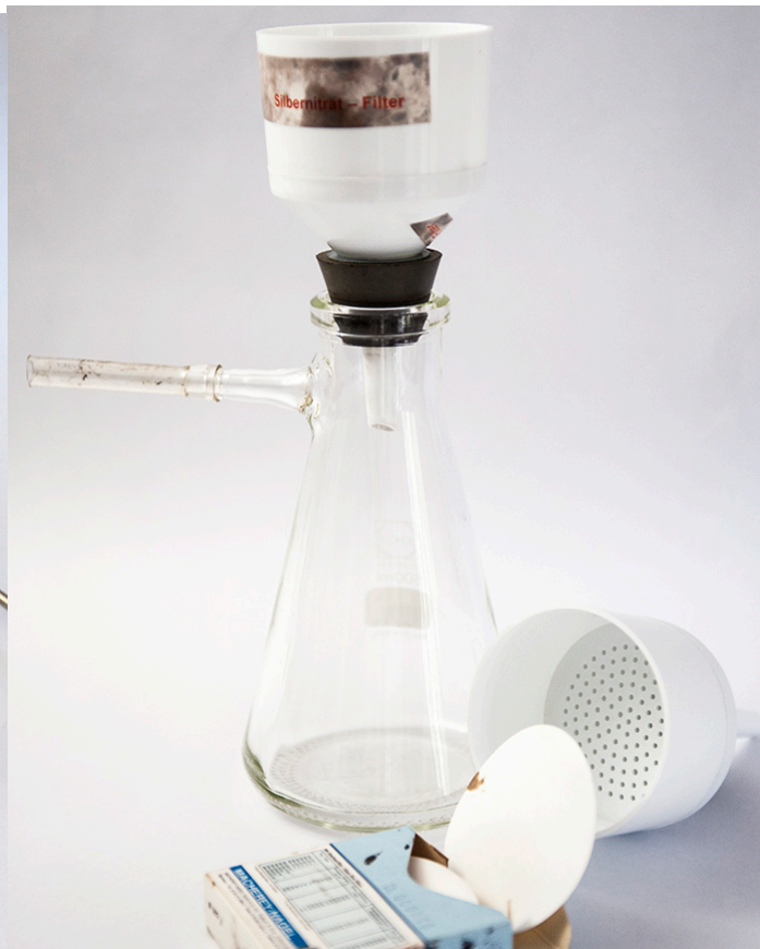
Dies sind verschiedene Laborutensilien zum messen, prüfen und reinigen. Links-oben: Ärometer zur Dichtemessung. Oben und oben-rechts: Vorrichtung zum Decantieren des Silberbad. Unten-rechts: Filternutsche und Erlenmaierkolben mit Anschluss für eine Vacuumpumpe. Unten-links: Waage, Thermometer, PH-Teststreifen
