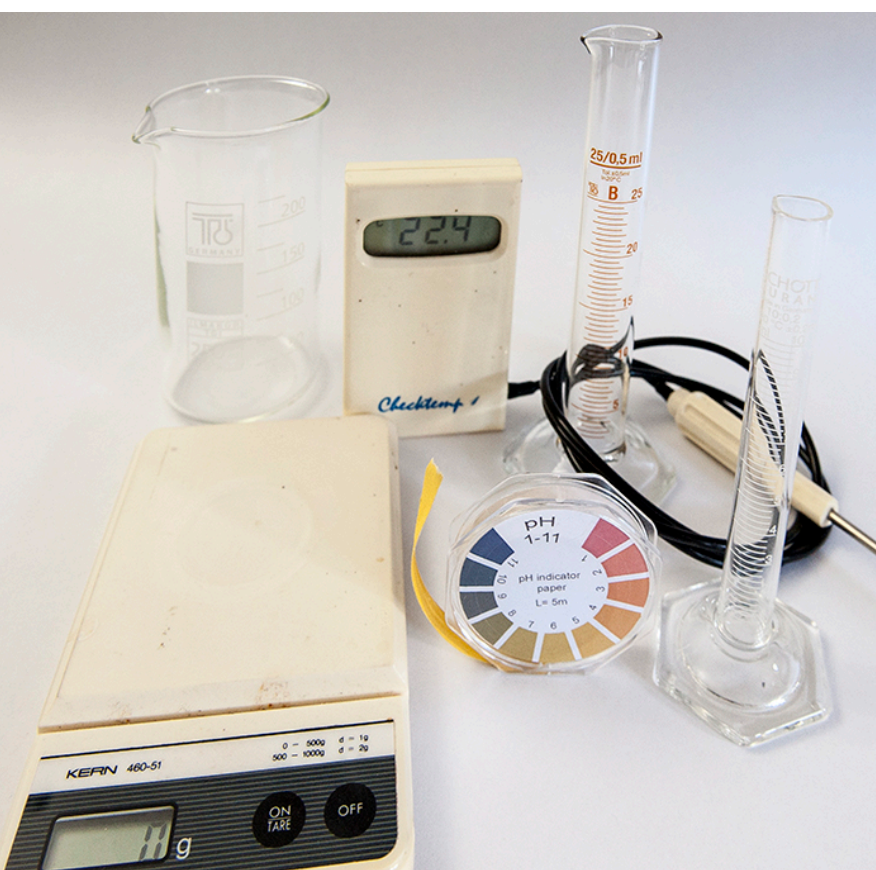
Dies sind verschiedene Laborutensilien zum messen, prüfen und reinigen. Links-oben: Ärometer zur Dichtemessung. Oben und oben-rechts: Vorrichtung zum Decantieren des Silberbad. Unten-rechts: Filternutsche und Erlenmaierkolben mit Anschluss für eine Vacuumpumpe. Unten-links: Waage, Thermometer, PH-Teststreifen
