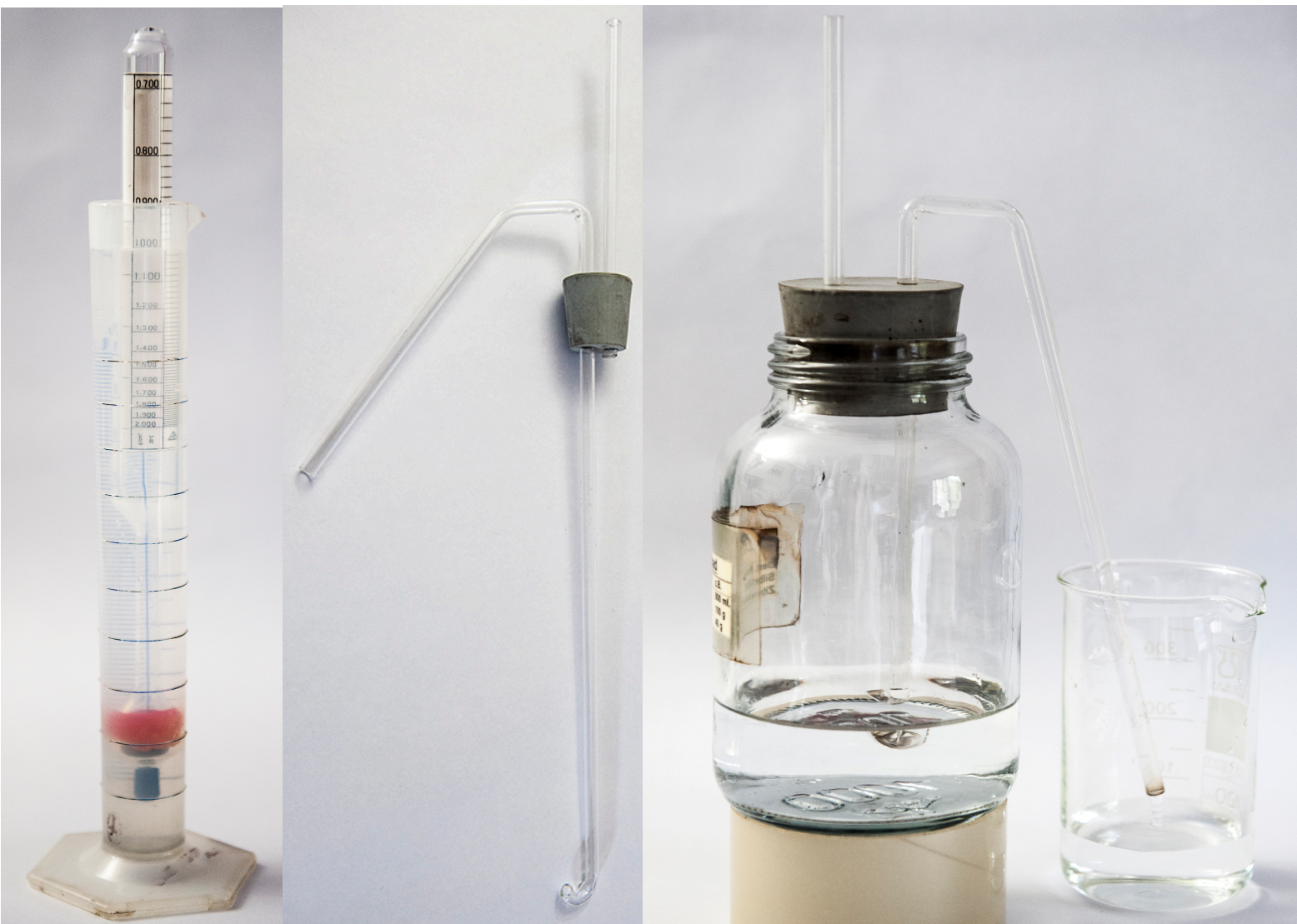
Dies sind verschiedene Laborutensilien zum messen, prüfen und reinigen. Links-oben: Ärometer zur Dichtemessung. Oben und oben-rechts: Vorrichtung zum Decantieren des Silberbad. Unten-rechts: Filternutsche und Erlenmaierkolben mit Anschluss für eine Vacuumpumpe. Unten-links: Waage, Thermometer, PH-Teststreifen
